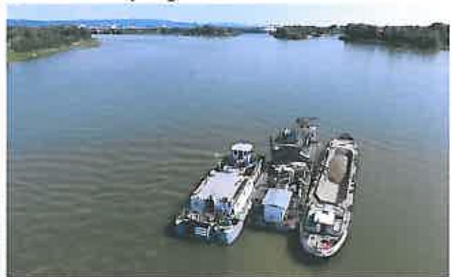
Obr.: Korčekový bager a súvisiace zariadenia
