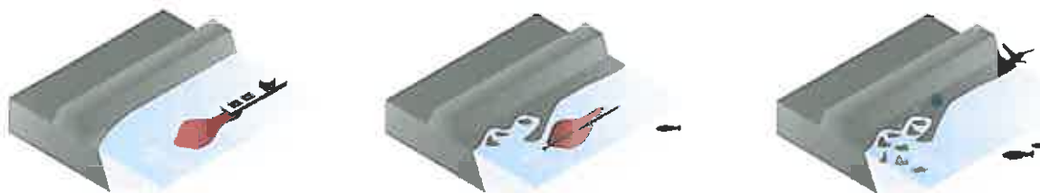
Obr.: Znárodnenie navrátenia sedimentov späť do koryta rieky (vybudovanie ostrovov)
